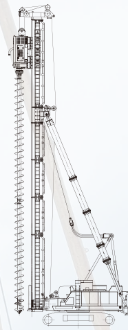
履带桩架挂FSA钻机 长螺旋法施工
